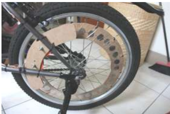
強力環狀磁鐵固定在腳踏車的後輪上
