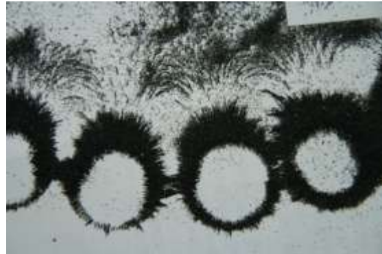
由磁力線發現磁鐵的磁力集中在磁鐵的周圍
