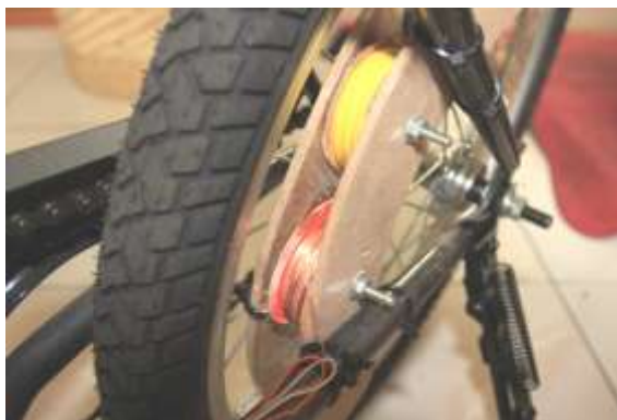
感應線圈固定於腳踏車的後支架上
