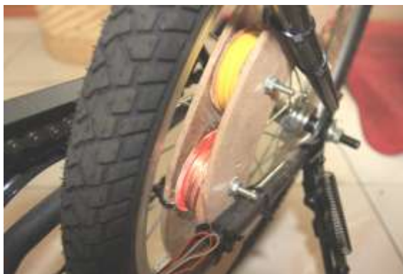
感應線圈固定於腳踏車的後支架上
